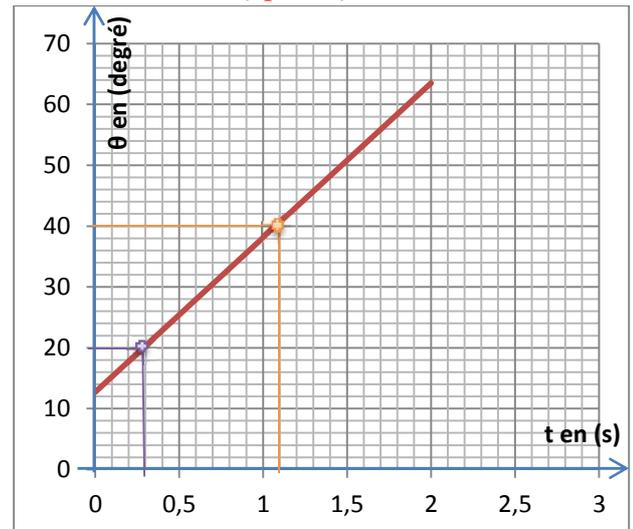
d'où :  $\omega = \frac{(0,7 - 0,35) \text{ rad}}{(1,1 - 0,3) \text{ s}} = \frac{0,35}{0,8} = 0,437 \text{ rad/s}$
